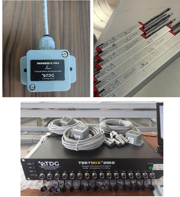
Zorlanmış titreşim deneylerinde kullanılan ölçüm ekipmanları
