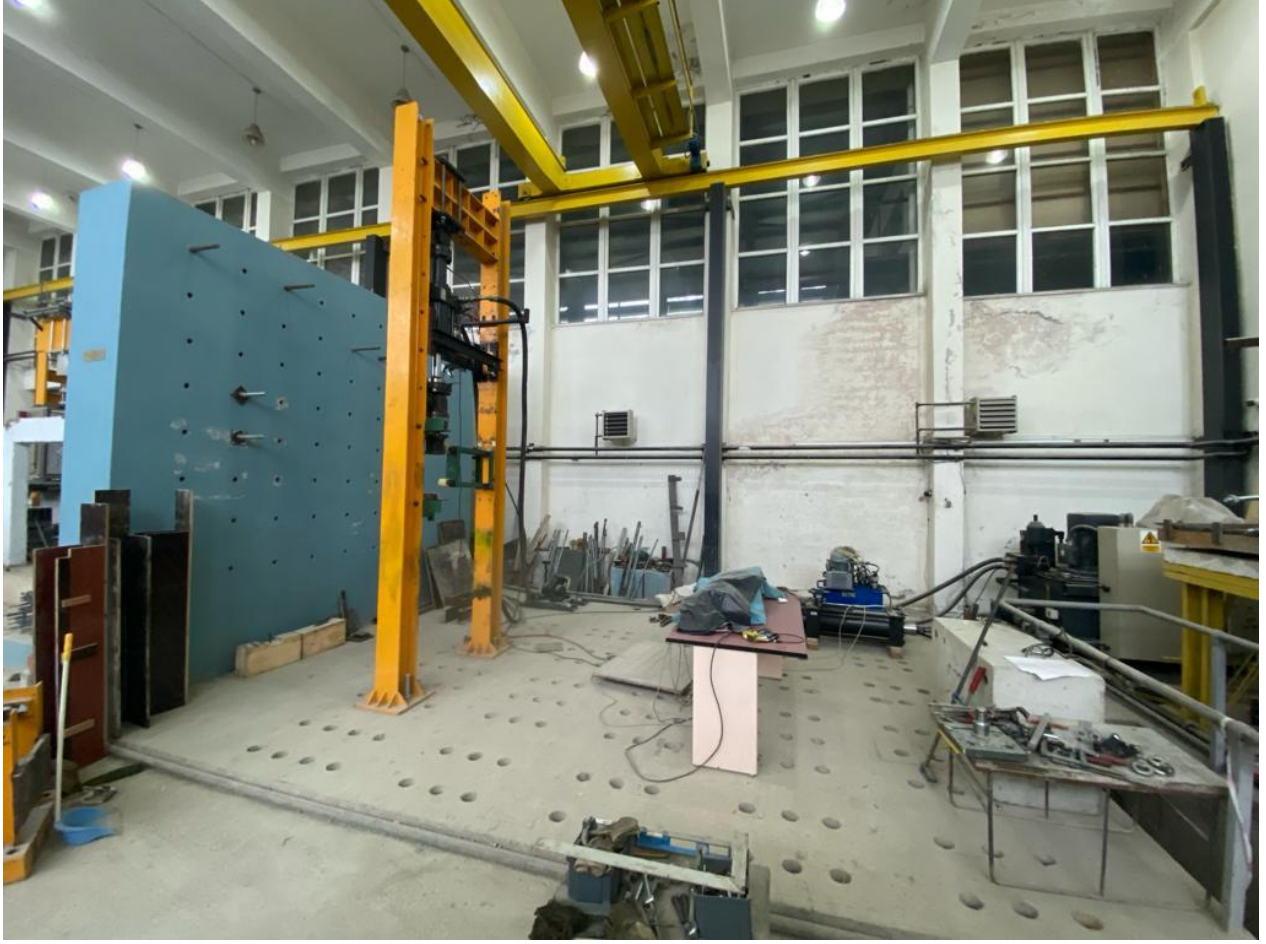
Kuvvetli zemin ve reaksiyon duvarı-1
