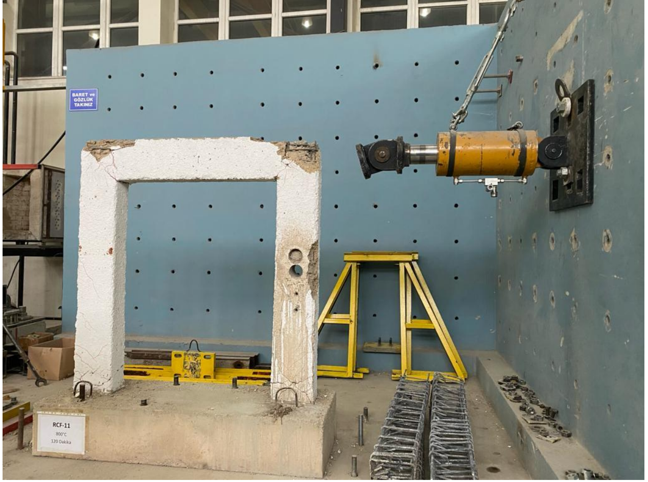
Kuvvetli zemin ve reaksiyon duvarı-2
