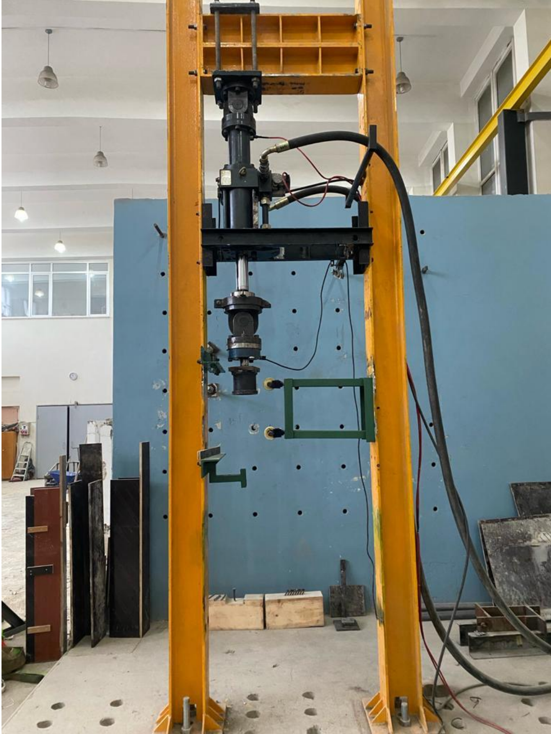
Farklı deneyler için kullanılabilen yükseklik ayarlı düşey yükleme sistemi
