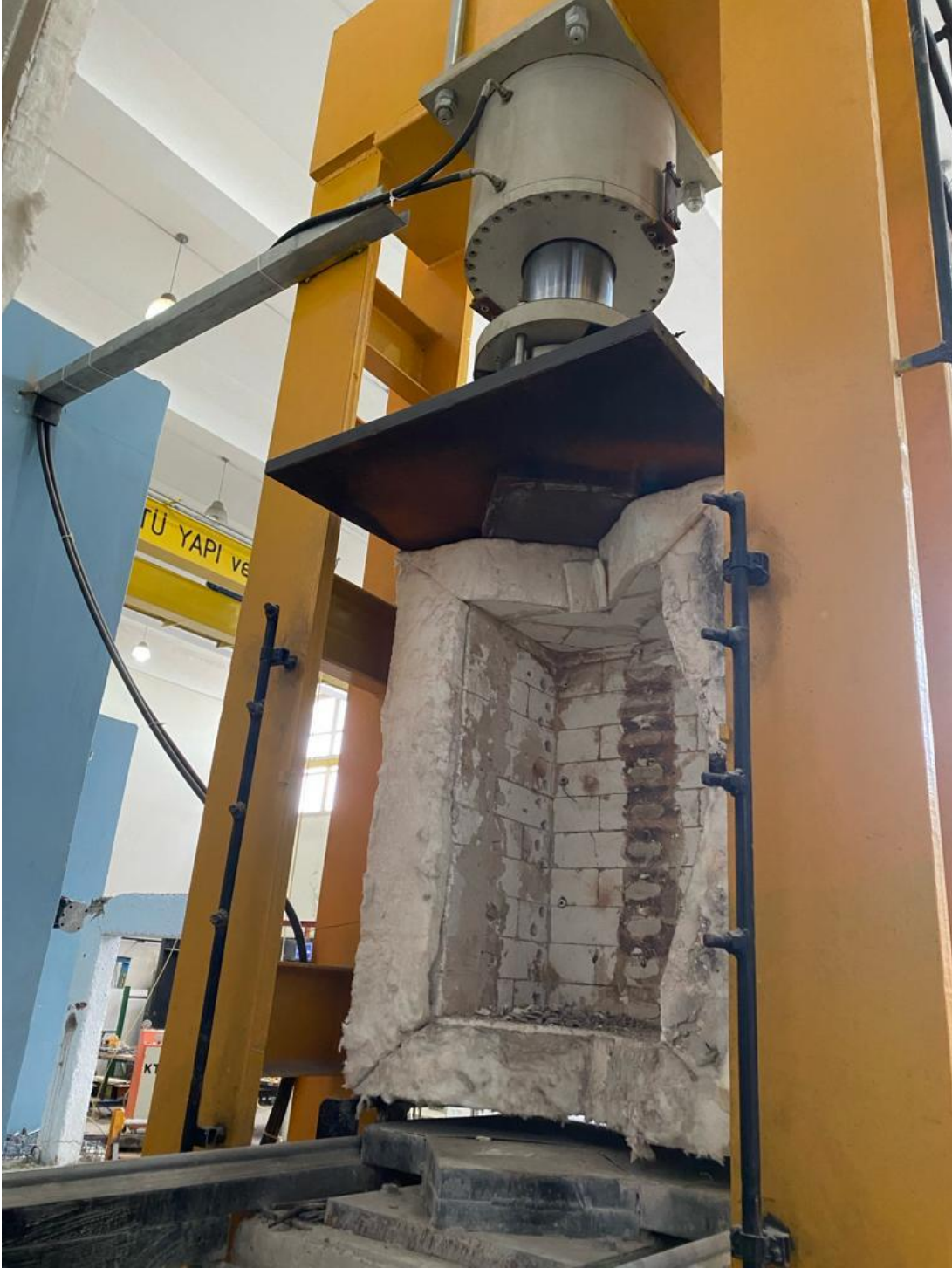
Kolonların aksenal ykleme sırasında ısıtılıp soğutulabildiđi yksek sıcaklık deney sistemi
