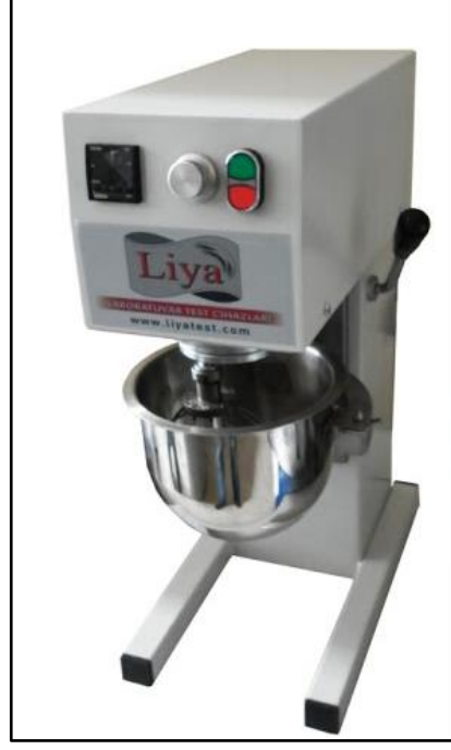
Şekil 2.6. Liya Beton Mikseri
