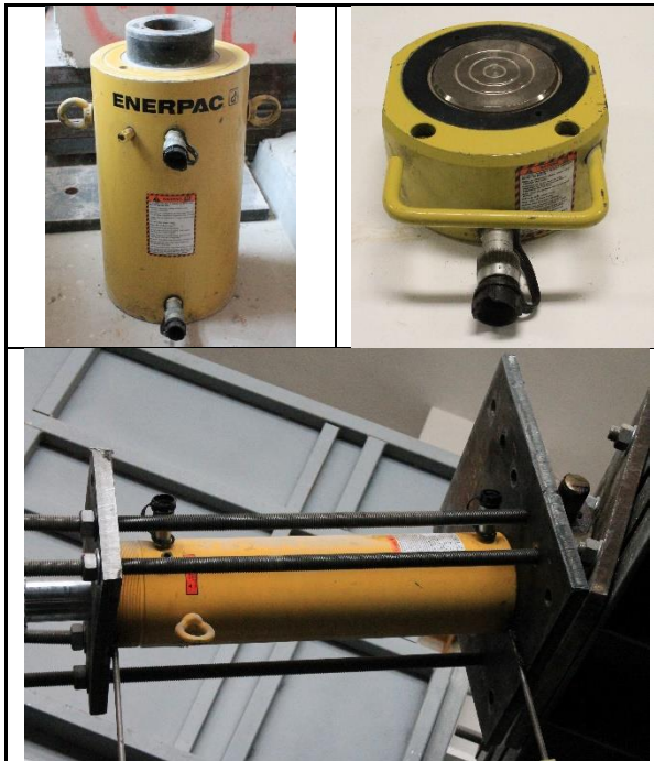
Manuel Kontrollü Hidrolik Pistonlar Piston uzunluk kapasitesi (16-460 mm) Yük kapasitesi (90-1800 kN)
