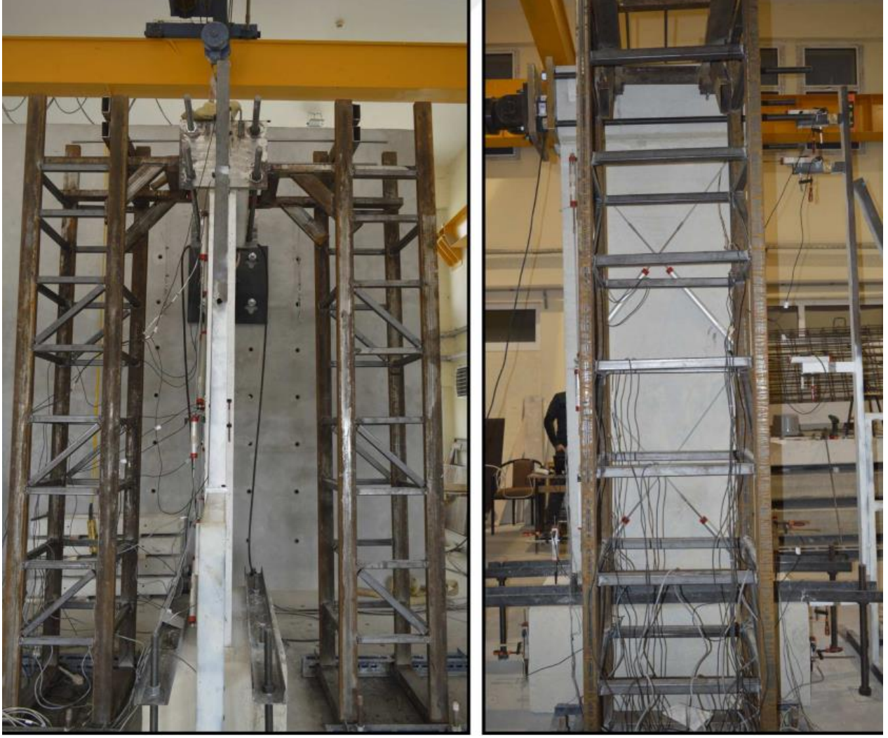
Perde duvarların çevrimsel yükler altında davranışının belirlendiği deney düzeneği
