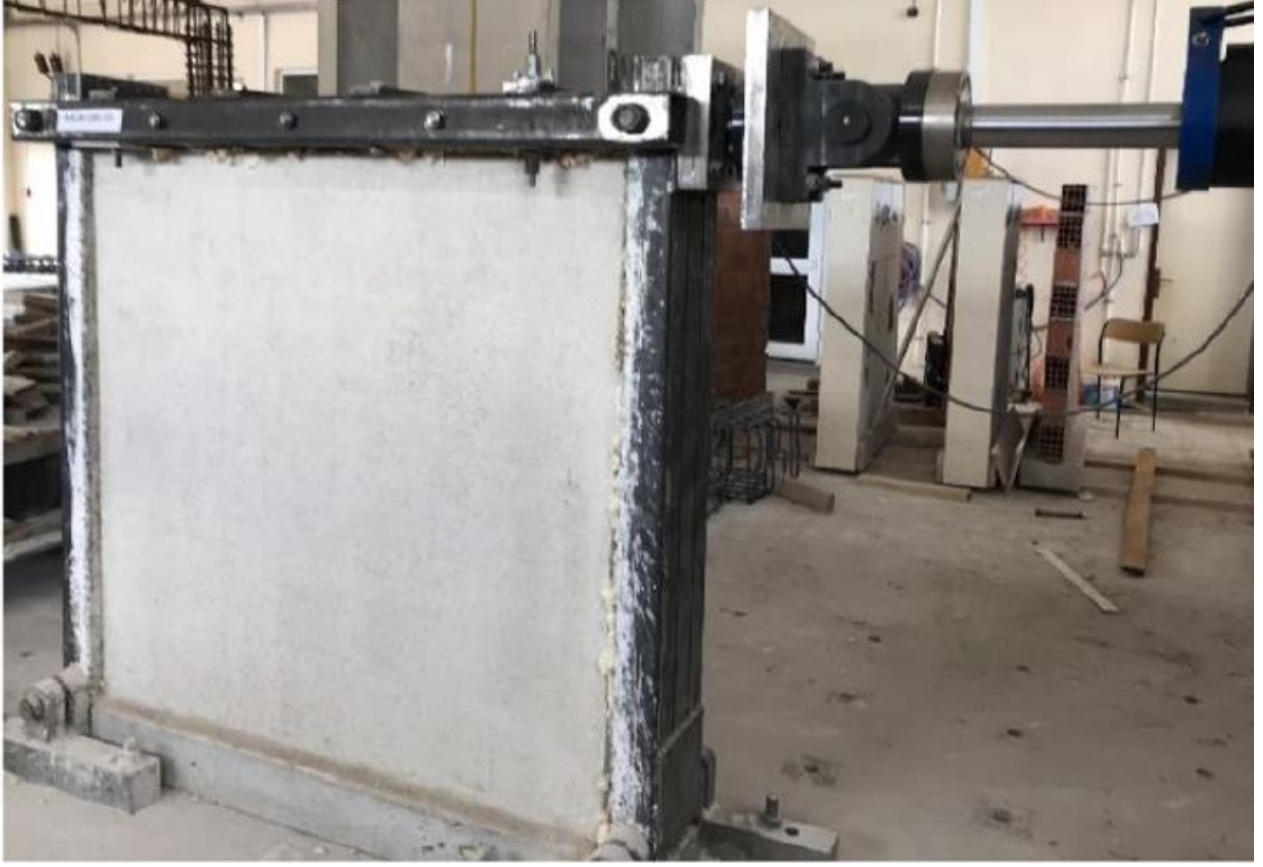
Servo-hidrolik aktüatör ile duvarlara uygulanan çevrimsel yük deney düzeneđi
