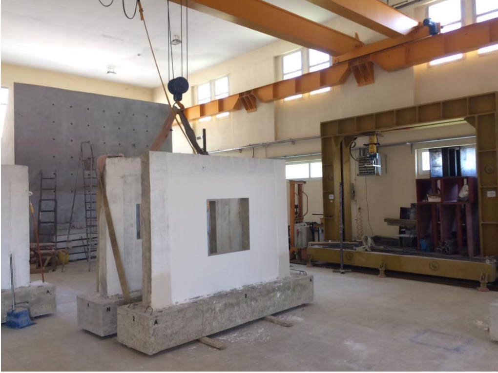
Rijit döşeme, reaksiyon duvarı ve yükleme çerçevesi
