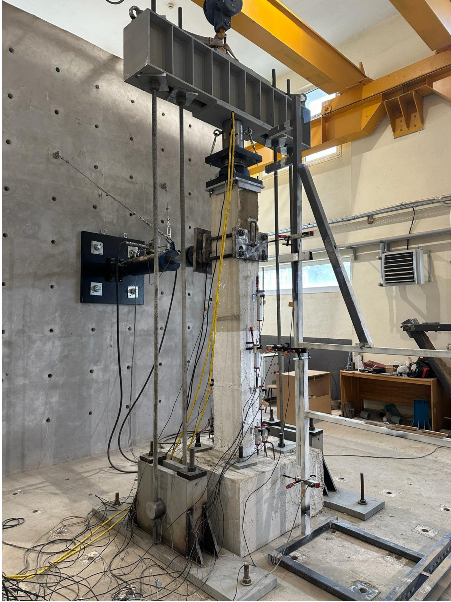
Farklı deneyler için kullanılabilen yükseklik ayarlı eksenel yük deney düzeneği
